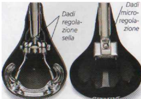
Bloccaggio tradizionale Con microregolazione
