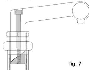
L'attacco con estensione è dotato di un riferimento stampato od inciso sull'estensione stessa che ne indica "l'inserimento minimo" o "l'estensione massima". Tale inserimento non deve essere visibile al di sopra della serie sterzo.
