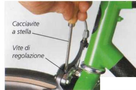
**2 MESSA A PUNTO** In caso di lasco o durezza nella frenata, intervenite sui perni. Allentate il controdado, stringete a fondo in senso orario la vite e quindi riallentatela poco a poco. Bloccate la vite con una brugola e stringete il controdado. Azionate il freno e regolate se necessario. Periodicamente le vite dei perni vanno smontate, pulite e lubrificate.
