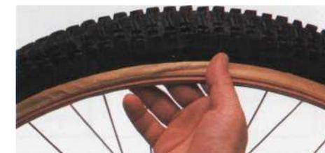
**RIPARAZIONE (continua)****6 SOSTITUIRE LA CAMERA D'ARIA**
