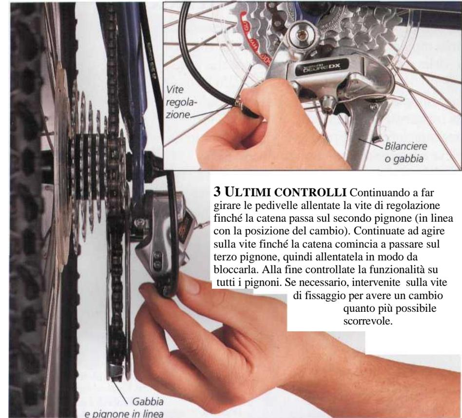
**3 ULTIMI CONTROLLI** Continuando a far girare le pedivelle allentate la vite di regolazione finché la catena passa sul secondo pignone (in linea con la posizione del cambio). Continuate ad agire sulla vite finché la catena comincia a passare sul terzo pignone, quindi allentatela in modo da bloccarla. Alla fine controllate la funzionalità su tutti i pignoni. Se necessario, intervenite sulla vite di fissaggio per avere un cambio quanto più possibile scorrevole.
